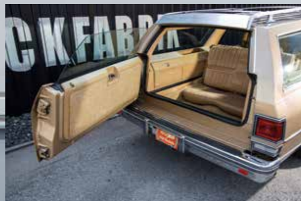
Die Kofferraumtür lässt sich nach unten klappen oder zur Seite öffnen, so wird der Zugang zur aus dem Boden aufklappbaren dritten Sitzreihe erleichtert.
