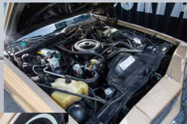
Nicht auf Höchstleistung getrimmt, dafür durchzugstark und zuverlässig: der 307-ci-Oldsmobile-"Rocket"-V8.
